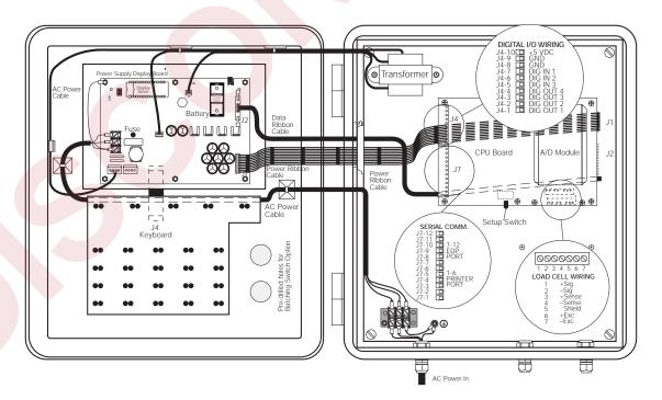
Figure 2-4. IQ plus 810 HE Wiring
