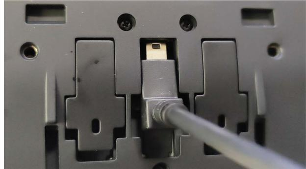
Illustration 3-7. Insertion du câble USB dans le port USB
