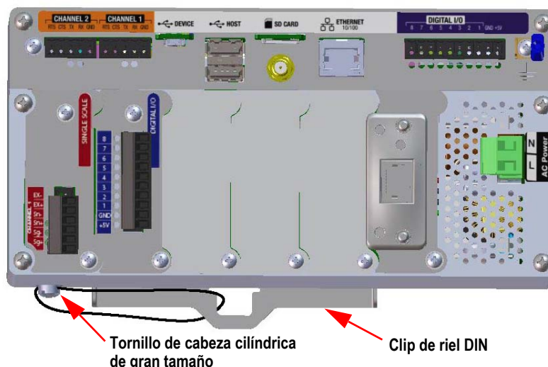
Figura 2-22. Precintado del interruptor de configuración (carcasa de montaje en panel)
