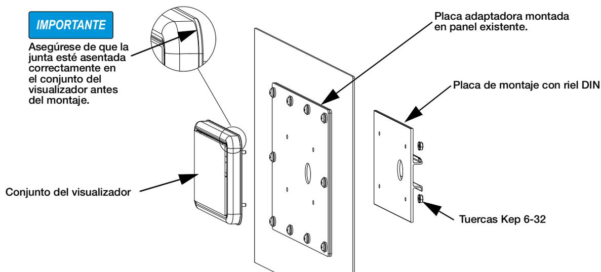
Figura 5. Instalación del visualizador
