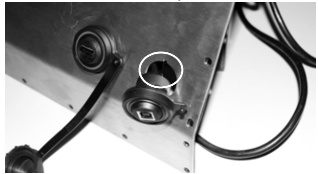
Figura 2-1. Conectores herméticos USB, en la tapa posterior
