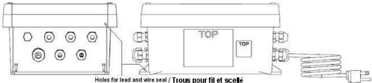
Sealing on iQube2-zAy. Device is sealed with two(2) seals on opposing corners. / Scellage pour l'iQube2-zAy. L'appareil est scellé avec deux(2) scellés sur les coins opposés.
