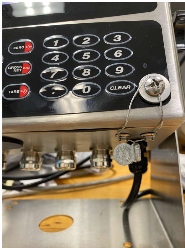
Typical sealing on front panel enclosure of model 1280-2y / Scellage typique sur panneau frontal pour le modèle 1280-2y
