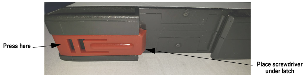
Figure 2-1. Remove DIN Latch
