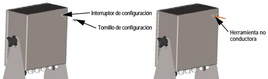
Imagen 3-1. Ubicación del interruptor de configuración (Gabinete universal)
