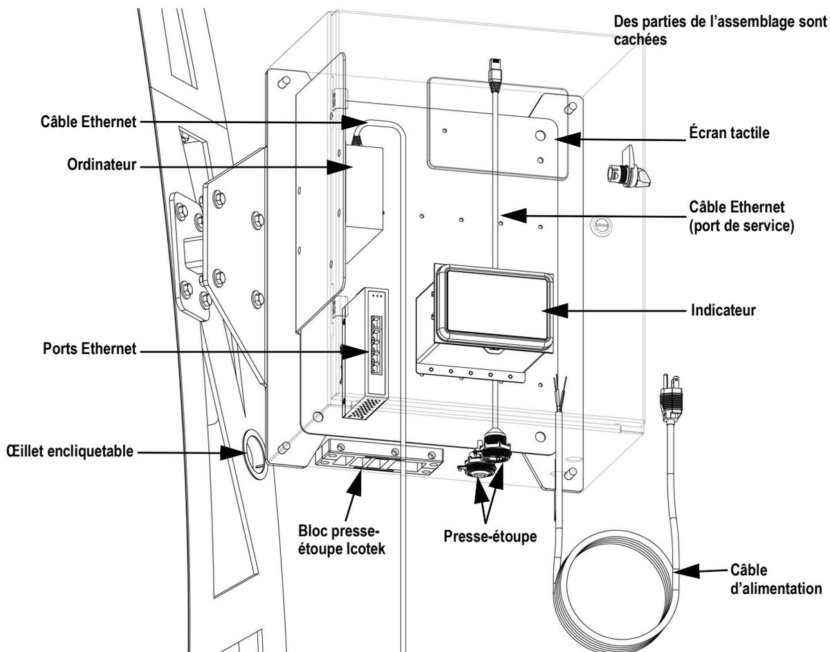
Illustration 3-19. Assemblage du poste en cabine métallique
