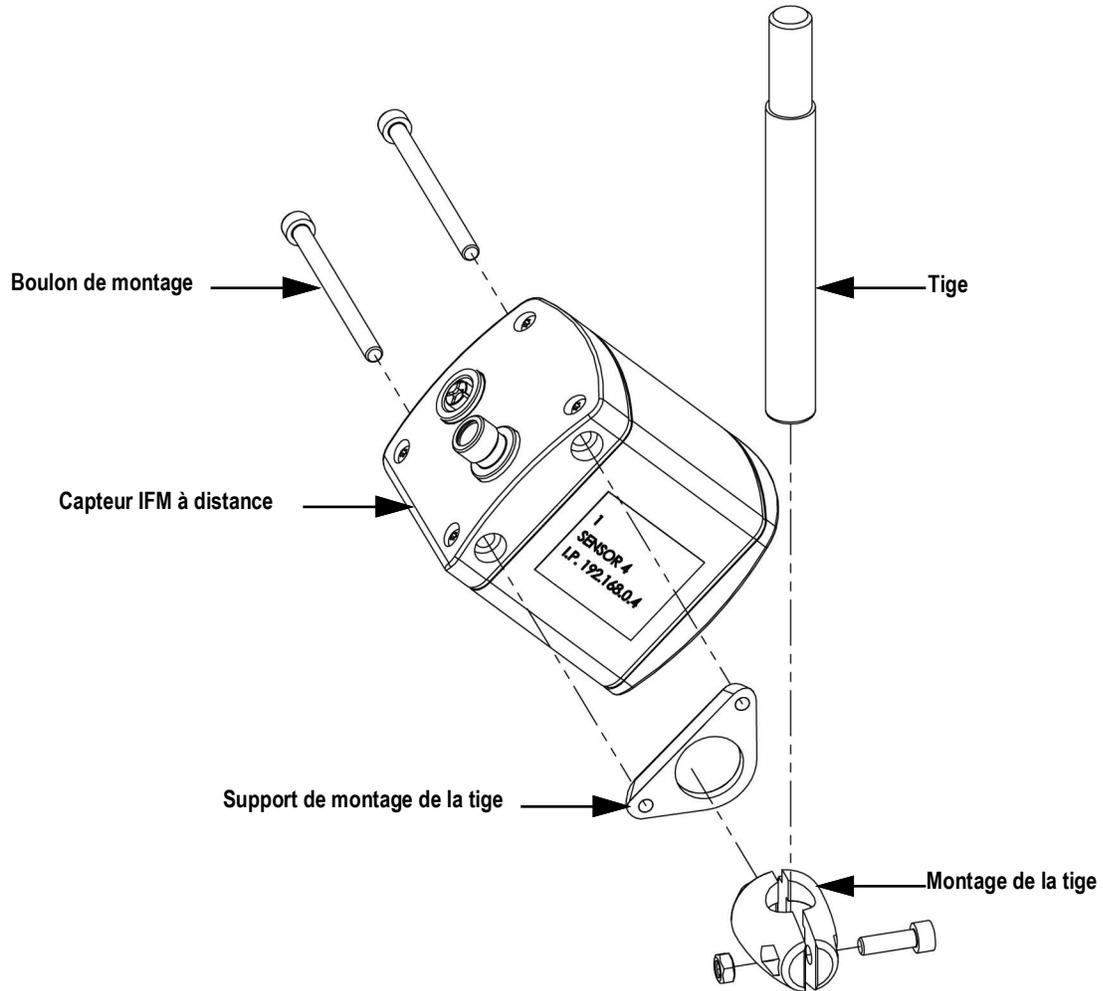
Illustration 3-10. Assemblage du capteur IFM à distance
