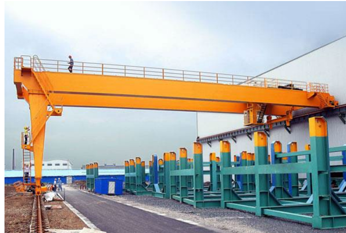
Grúa semi pórtico
