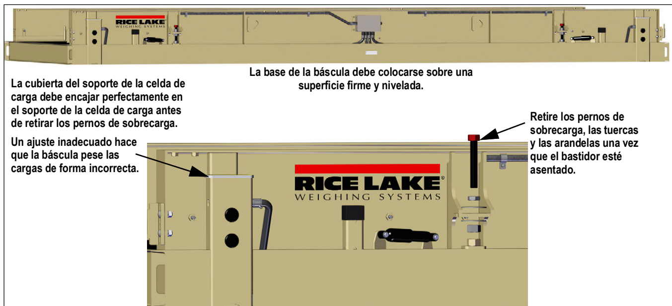
Figura 2-1. Bastidor base de la báscula y pernos de sobrecarga
