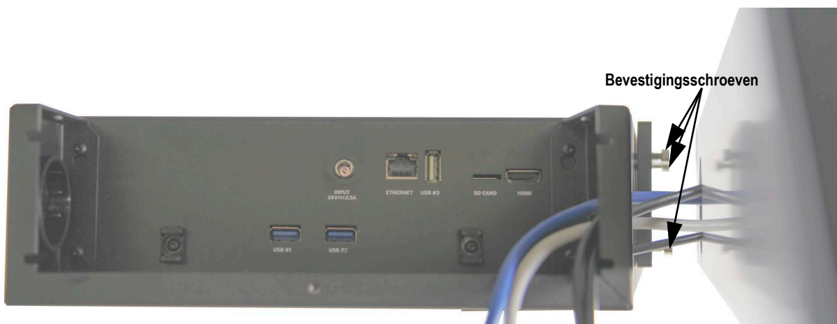
Afbeelding 3-13. Kabels door kop voeren
