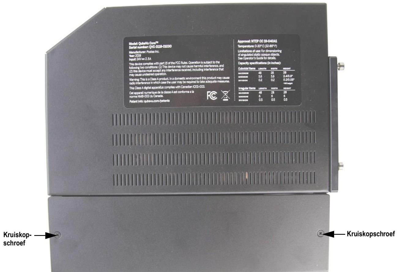
Afbeelding 3-18. Scankop met vastgezette achterste afdekking
