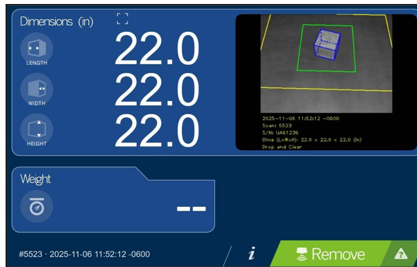
Afbeelding 6-43. Kalibratie hangend dimensioneringssysteem geverifieerd
