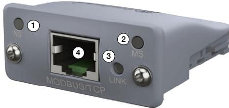
Figure 2-5. Modbus TCP Status LED Module
