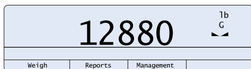
Figure 7-3. Pantalla 720i mostrando las teclas programables del Modo de Avance
