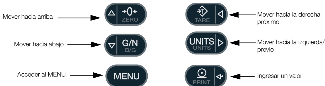
Figura 3-5. Funciones de las teclas del panel frontal en el Modo de Configuración
