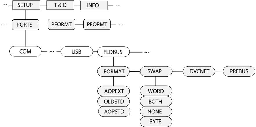
Figure 3-7. Fieldbus Menu Parameters
