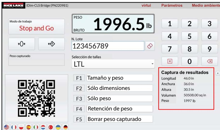
Figura 6-3. iDim CLS Bridge con resultados de captura (usando dimensionador)
