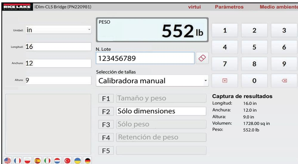
Figura 6-7. iDim CLS Bridge con resultados de captura (dimensionador manual)
