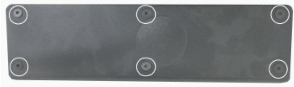
Illustration 7. Emplacement des nouvelles vis arrière (encerclé)
