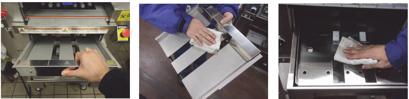
Figura 6. Limpieza de la Platina y Área de Avance
