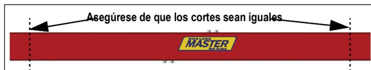
Figura 2-7. Redimensionar el bastidor de pesaje – 311M solo
