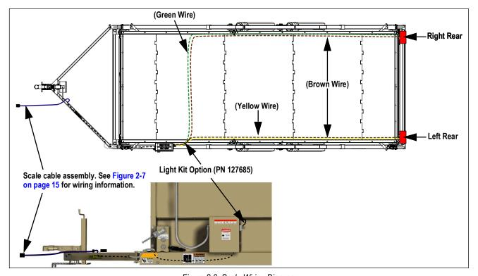
Figure 2-9. Scale Wiring Diagram
