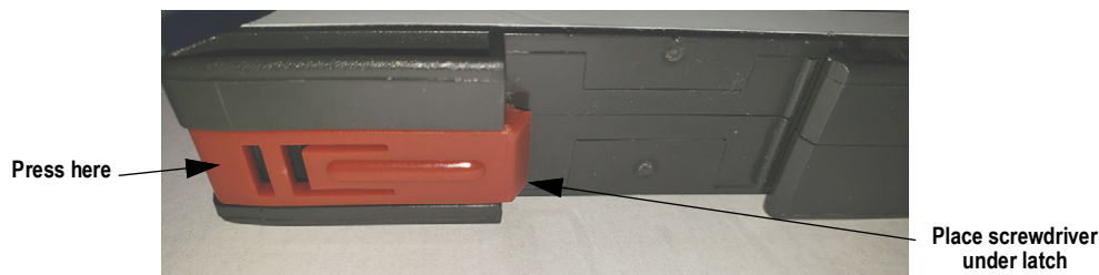
Figure 2-1. Remove DIN Latch
